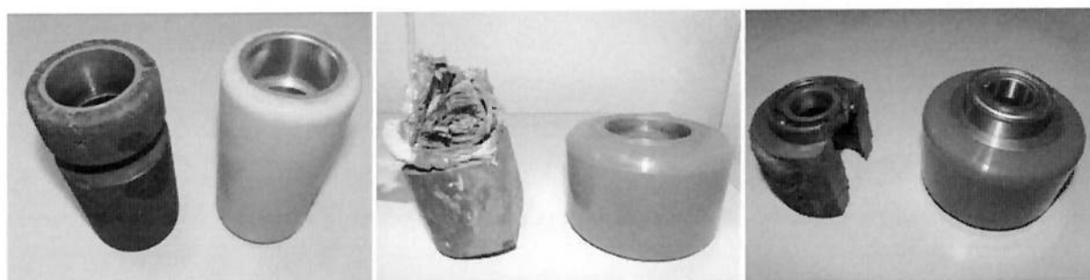
Figura 10 – Exemplo de Rodas Danificadas por Mau-uso
